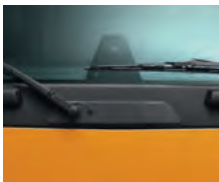
→ Sensores de seguridad Unos sensores ultrasónicos de presencia detectan a usuarios vulnerables en el lado opuesto al conductor. La alerta generada es visual (LED) y sonora.
