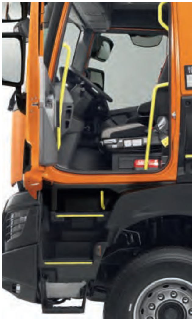
→ Escalones de acceso a la cabina/ pasamanos de color amarillo Más seguridad al entrar y salir del vehículo.
