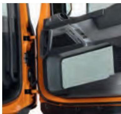
→ Puerta visión La puerta del acompañante tiene un cristal adicional a la altura de ciclistas y peatones.
