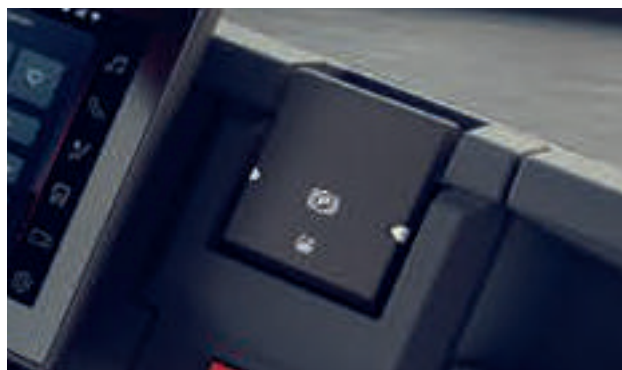
→ Modo de seguridad Vehículo inmovilizado en caso de apertura de la puerta del conductor.
